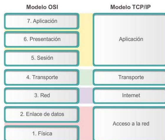
Comparación del modelo OSI con el modelo TCP/IP
