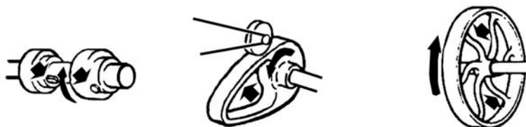
Fig. 1.16.-Movimiento de rotación. Salientes y aberturas
