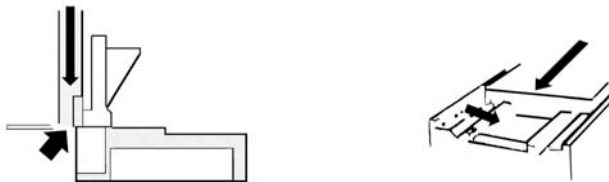
Fig. 1.21.-Movimientos alternativos y de traslación. Formas de aproximación
