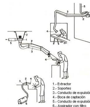
En las operaciones de soldadura con hilo continuo y atmósfera protectora *se ha sugerido el empleo de extracciones acopladas a la propia boquilla de soldadura*. El caudal necesario en estos casos
