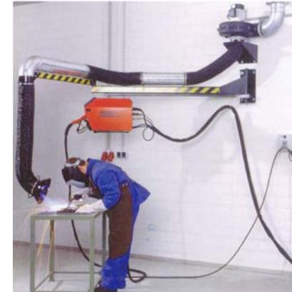
En industrias grandes en los que existan varios de puntos de trabajo se pueden instalar varios de estos *equipos en batería* unidos a *un conducto principal del que absorbe un extractor general*. Estas instalaciones *se deben calcular adecuadamente* ya que si la pérdida de presión en su red debido a los múltiples puntos de captación es muy elevada la extracción será inadecuada.
