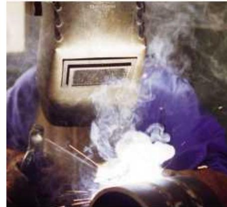
Por regla general, *se puede soldar con electrodos recubiertos con fúndente*, que facilitan la estabilidad del arco y con ello, su manutención influenciando benéficamente la calidad del cordón de soldadura. El revestimiento ocasiona una corriente superficial de escoria y una protección gaseosa, que permite aislar al material del oxígeno y del nitrógeno del aire. Se puede soldar con electrodos desnudos, solamente cuando no se pretende obtener uniones de alta resistencia.
