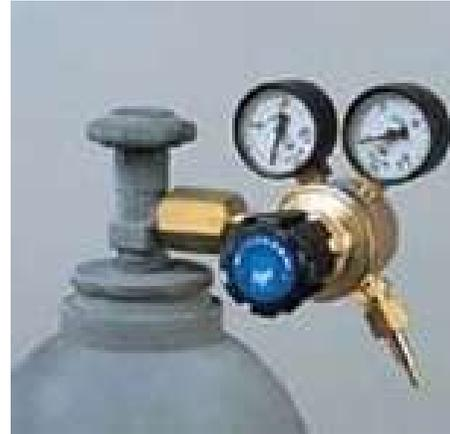
Cuando se requiere mejorar la aportación de calor sin perder las ventajas típicas del argón, se recurre a las mezclas argón - helio. Para reducir la presión y control el caudal del gas *se utilizan manorreductores caudalímetro*. Estos aparatos suelen venir calibrados en litros por minuto. El caudal de gas, que depende del espesor y naturaleza del metal a soldar, puede regularse mediante un mando situado en el caudalímetro.
